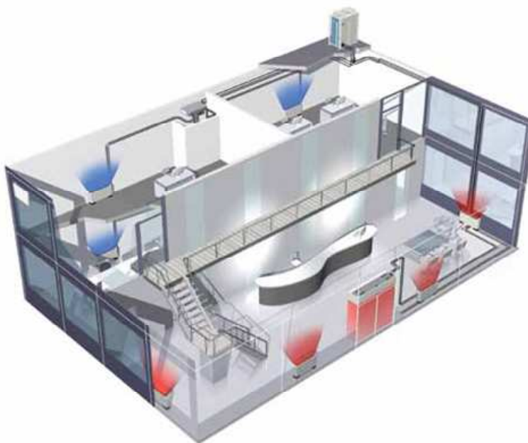
Ejemplo de instalación de una cortina de aire combinado con sistemas ERQ y VRV
